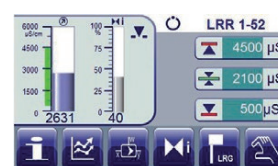
Grundbild mit Abschlämmung
